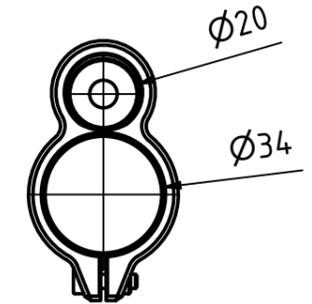
Während dem festdrehen des Barrelbands immer auf die Parallelität zwischen Lauf und Luftzylinder achten.
